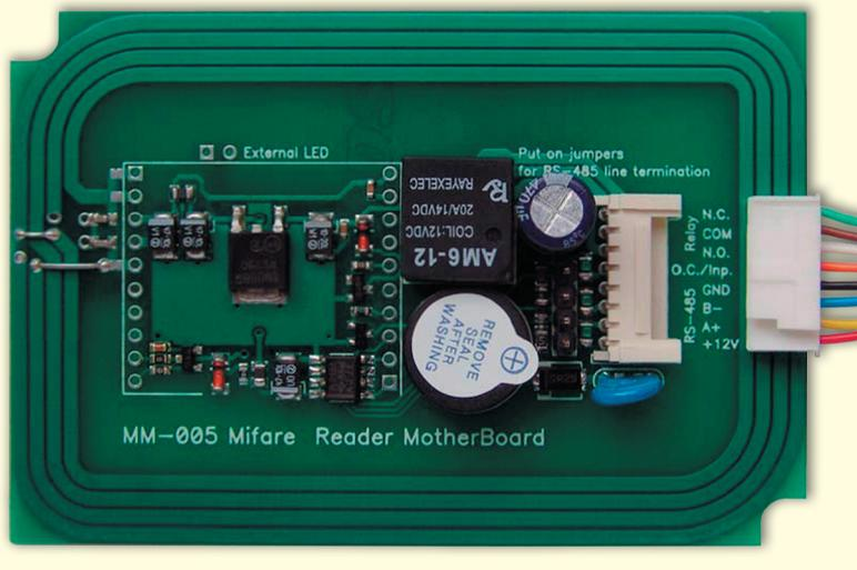
**Рисунок 2** Базовая плата MBM-005
