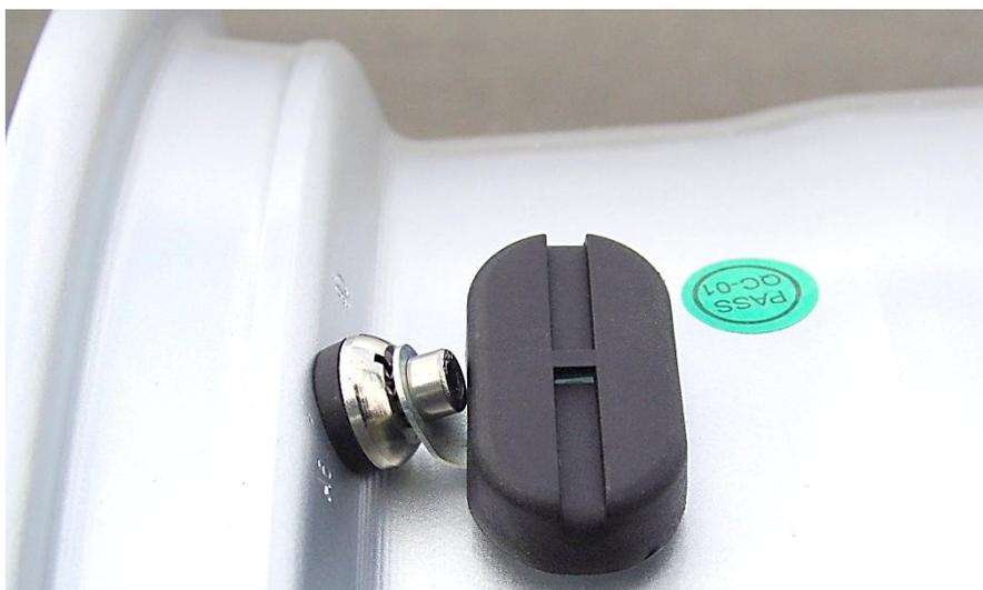
Гайка затягивается до плотной посадки вентиля в отверстии диска, но без чрезмерных усилий, способных повредить уплотнительную резиновую втулку.
